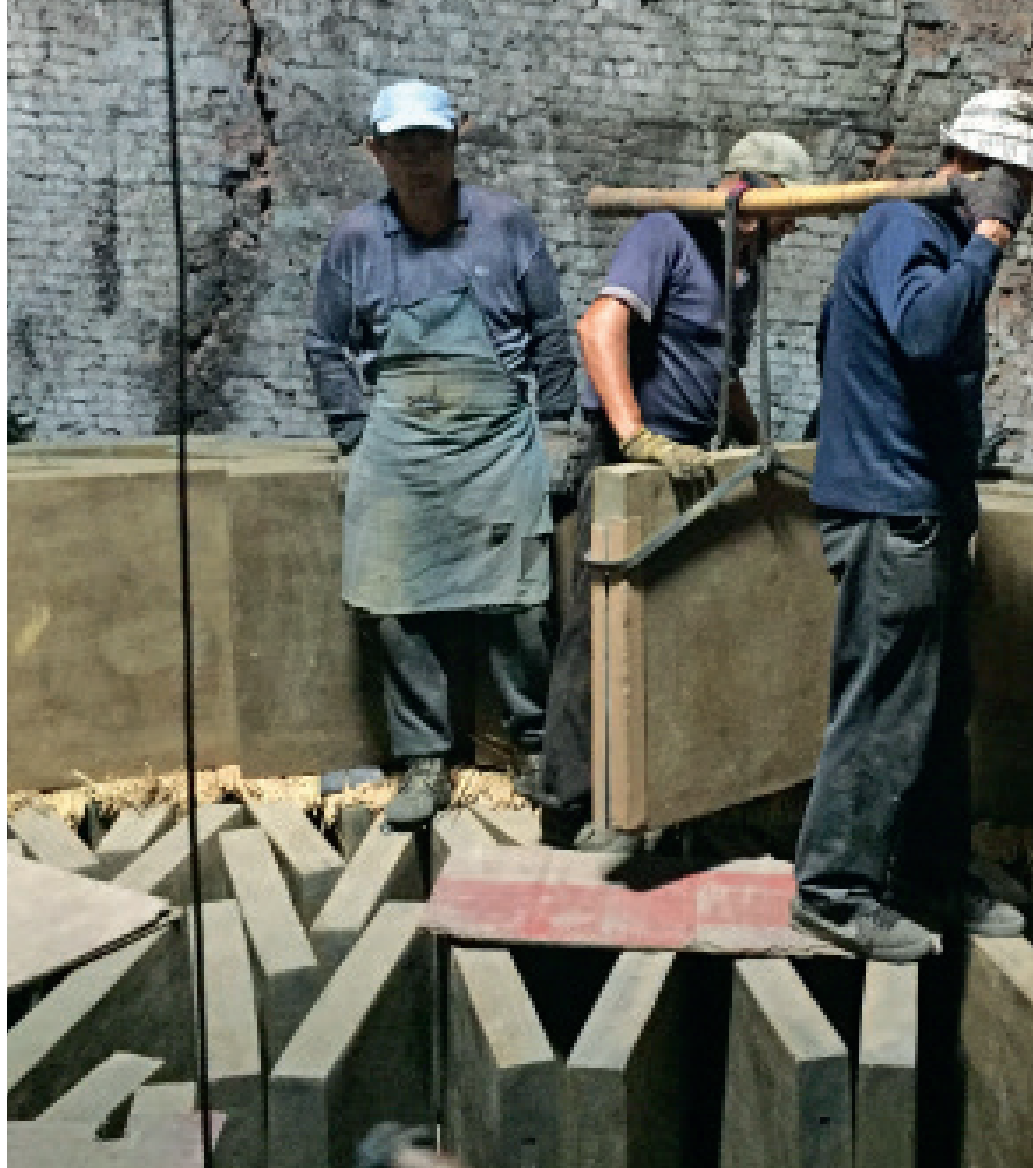
oben u. rechts - Beladen des Ofens: dies ist eine schwere und heikle Arbeit
