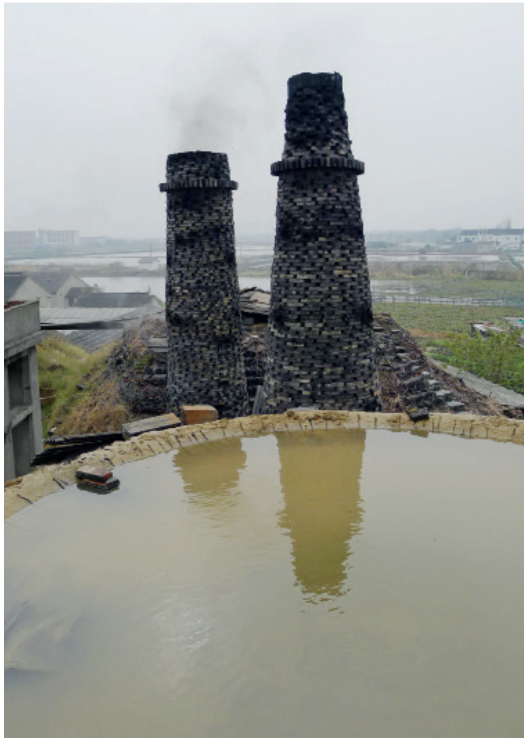
Lumu, Oberseite des Brennofens, mit Wasser gefüllt für die Reduktion
