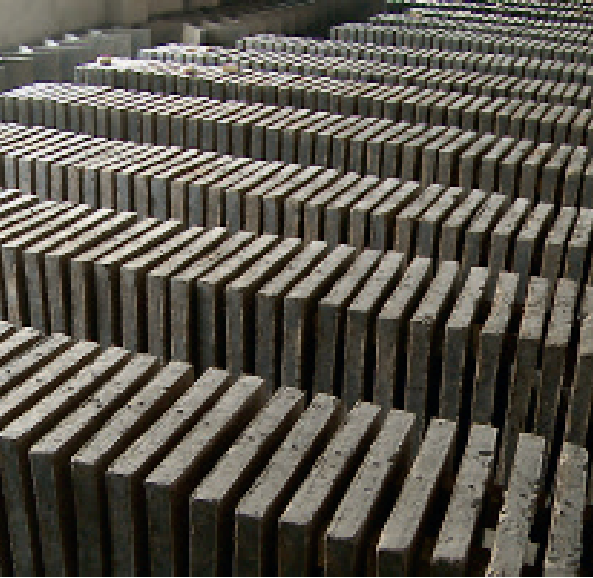
Trocknungsprozess: dieser kann, in diversen Schritten, bis zu 6 Monaten dauern
