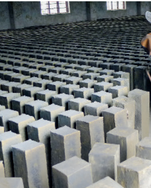
Trocknungsprozess: dieser kann, in diversen Schritten, bis zu 6 Monaten dauern
